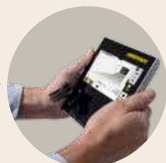
Controlador extraíble con funcionamiento táctil (véase página 58)
