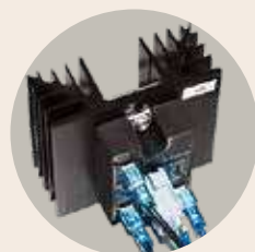
Conexión silenciosa de la calefacción con relé semiconductor
